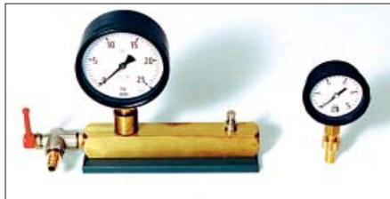
**Bild 3:** Prüfmanometer Klasse 1,0 mit Werk-Kalibrierschein als Kontrollinstrument. Kugelhahn mit Druckentlastung. Das zu überprüfende Manometer wird über den Anschlussstutzen angeschlossen.
