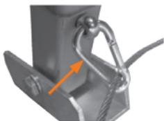
Fixer le cordage acier à l'aide d'un mousqueton sur la vis à œillet du 2ème pied.
