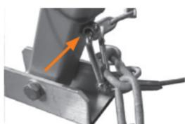
Закрепете халката на стоманеното въже с карабинер към римболта на единия крак на стойката. (Фигура 1 показва, допълнително към монтирането на халката на стоманеното въже, монтирания край на веригата от монтажна точка 4)
