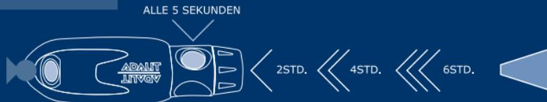
Tastenanschlag für Abschalten die Taste so lange halten, bis die Helmlampe mit einem weniger intensiven Licht nach dem ersten wiederholten Aufleuchten zum Anzeigen des Ladezustandes wieder leuchtet.
