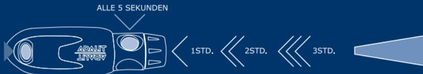
Weiße LED leuchtet auf: Das Blinken am Anfang gibt den Ladezustand an: 3 x = 3 Std.; 2 x = 2 Std.; 1 x = 1 Std. Als Anzeige für schwache Batterie schaltet die LED nach 3 Stunden während 15 Minuten alle 15 Sekunden für je 0,25 Sekunden aus.
