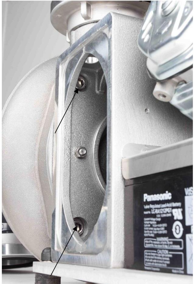
7. Setzen sie die Edelstahlabdeckung auf den Lagerbock zwischen Spiralgehäuse und Motor und schrauben Sie die vier Sechskantschrauben mit Beilagscheibe (M5) und die Aufhängeöse fest.
