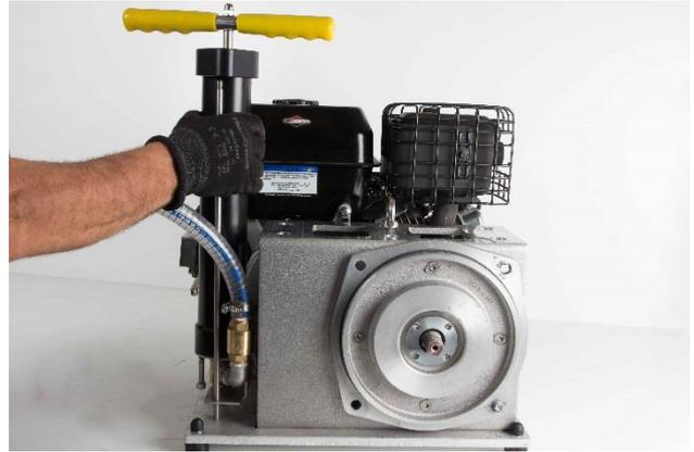
3. Entfernen Sie mit einem Montageeisen die Spannfeder im Riemenspanner.
