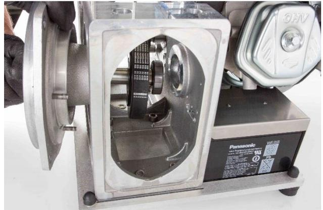
7. Achten Sie darauf, dass sich der Klemmring im hinteren Lagersitz befindet. Sollte dieser herausgefallen sein, setzen Sie ihn wieder ein.
