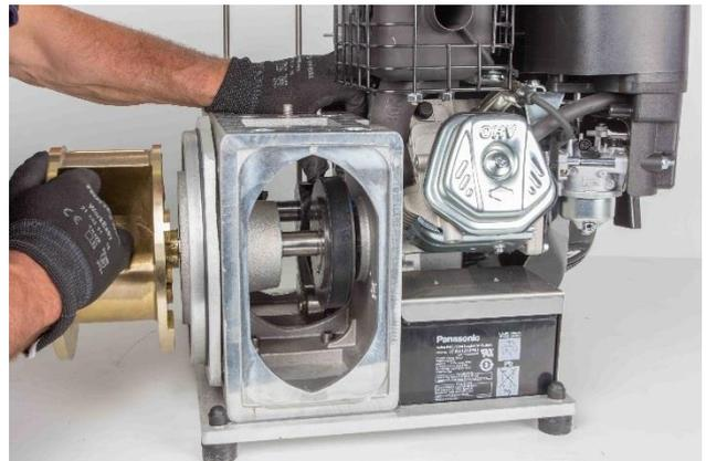
5. Setzen Sie die Spannfeder mit einem Montageeisen in den Riemenspanner ein. Achten sie darauf, dass die Feder in den Halterungen an der Spannschraube und am Riemenspanner exakt eingelegt und geführt ist. Durch den Druck der Feder wird der Riemenspanner an den Keilrippenriemen gedrückt. Durch Herausdrehen oder Eindrehen der Spannschraube kann die Spannung des Keilrippenriemens eingestellt werden.
