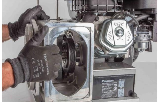
2. Montieren Sie die vier Muttern M8 am Lagerbock. (Auf dem Bild sind nur drei der vier Schrauben dargestellt.)
