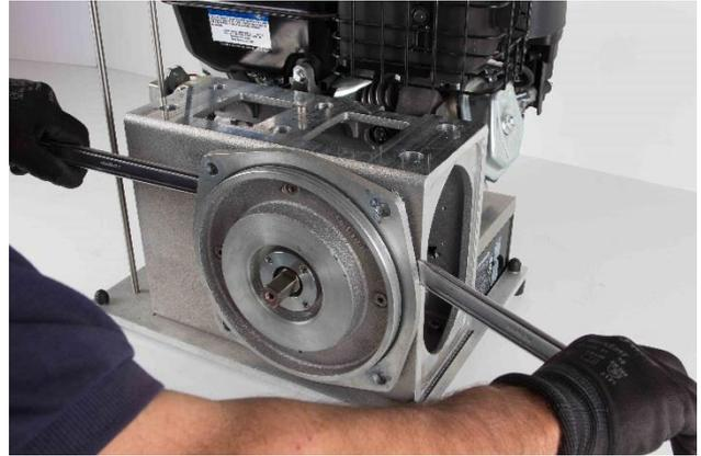
6. Nehmen Sie den Motorflansch aus dem Lagerbock und entfernen Sie den Keilrippenriemen.
