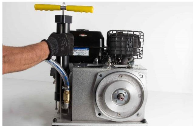
3. Befestigen Sie die zwei Muttern M8 an der Ansaugpumpe.
