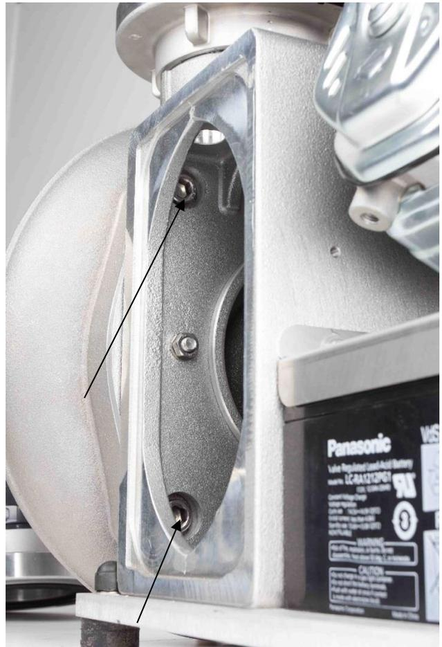
4. Entfernen Sie das Spiralgehäuse. Bei hartnäckigen Verstopfungen ist es gegebenenfalls notwendig mit Hilfe von zwei Montageeisen das Spiralgehäuse zu entfernen. Setzen Sie hierzu die Montageeisen an den beiden dafür vorgesehenen Demontageschlitzern am Spiralgehäuse an und hebeln damit das Spiralgehäuse ab.
