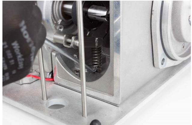
4. Entfernen Sie die vier Muttern M8 am Lagerbock. (Auf dem Bild sind nur drei der vier Schrauben dargestellt.)
