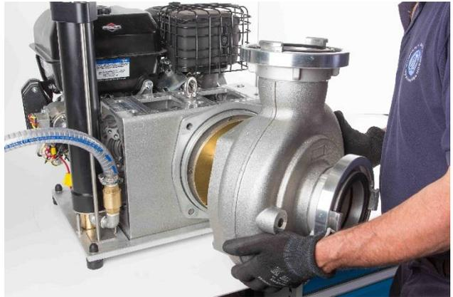
6. Schrauben Sie die vier Zylinderschrauben mit Innensechskant (M12), innerhalb des Lagerbockes, vom Motorflansch zum Spiralgehäuse, fest. (Auf dem Bild sind nur die beiden linken Schrauben dargestellt.)
