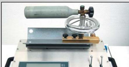
Bild 5: Füllkopf F2M für außenliegende CO<sub>2</sub>-Flaschen mit Drehventil bis 300 g
