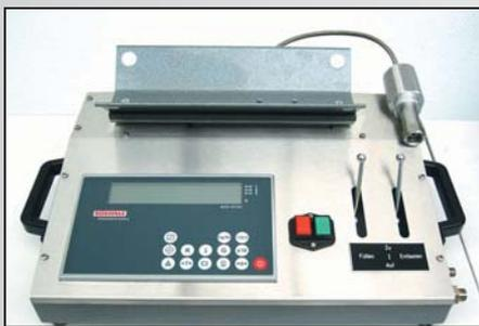
Bild 4: Ergänzungsteil Digital I mit automatisch abschaltender Waage und Füllkopf F3M für CO<sub>2</sub>-Flaschen bis 6 kg und CO<sub>2</sub>-Feuerlöscher von 2 - 6 kg
