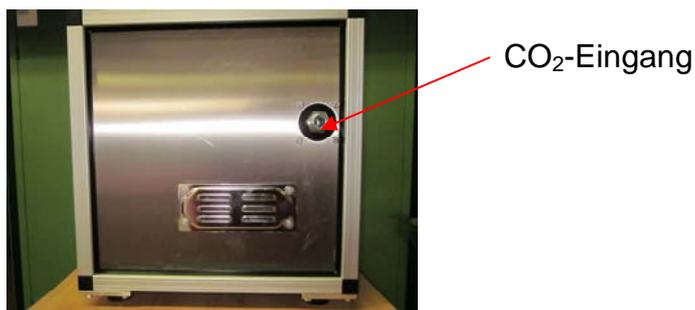
Anschließend den CO<sub>2</sub>-Ausgang des Pumpenstandes mittels Versorgungsschlauch (eventuell mit Hilfe einer geeigneten Rohrleitung) an den Eingang des Füllstandes anschließen.
