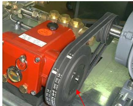
Riemenscheibe mit Taper-Spannbuchse
