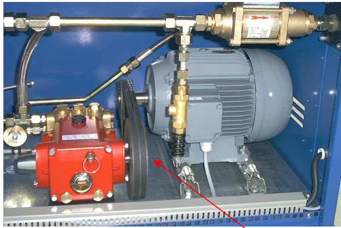
Riemenscheibe mit Taper-Spannbuchse
