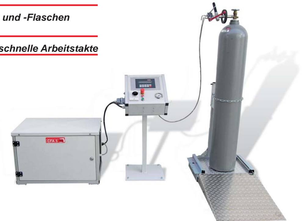
Bild 1: Die Kohlensäure-Füllanlage CFA 5 ist für das präzise CO 2 -Füllen aus der flüssigen Phase konzipiert. Es wird mit ihr tiefkalte Kohlensäure aus Niederdrucktanks (15 bis 20 bar) in CO 2 -Flaschen von 2 bis 50 kg gefüllt.
