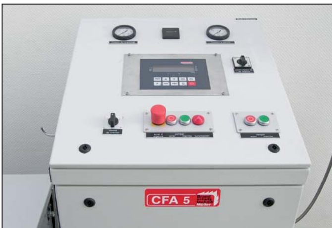
Bild 3: Der Steuerstand gewährleistet eine ergonomisch günstige Bedienung. Er enthält Anzeigen für Gewicht auf der Waage, Fülldruck, Umlaufvordruck, Überdruckkontrolle und einen Betriebsstundenzähler. Mit einem Wahlschalter können 3 verschiedene, freiprogrammierbare Abschaltgewichte für die Waage abgerufen werden.
