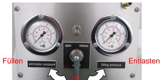
1. Füllschlauch anschließen (ggf. Handventil des Feuerlöschers während des Einfüllens offen halten).
