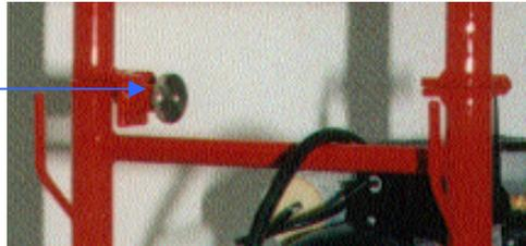
Durch Entriegelung am Entriegelungsknopf, lässt sich der Haltegriff am **HPP** umklappen und ermöglicht dadurch einen platz sparenden Transport.
