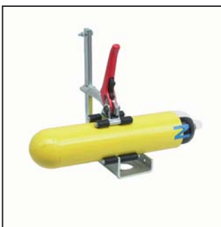
Bild 12: Mechanische Spannvorrichtung zur Demontage und Montage von Flaschenventilen. Die Anpressflächen sind gummiert.
