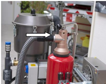
7. Stecken Sie den geerdeten Pulversaugschlauch der PSM auf den Alu – Rohrstützen des Absaugadapters.
