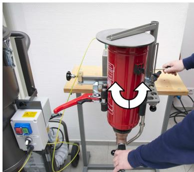
9. Schwenken oder drehen Sie den Feuerlöscher mehrfach um die horizontale Achse, damit die letzten Pulverreste lösen können.
