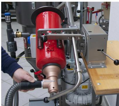
8. Lösen sie die Drehverriegelung und drehen Sie den Feuerlöschler vorsichtig mit der Armaturenöffnung nach unten.
