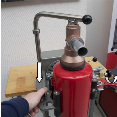
6. Spannhebel nach unten drücken (ggf. mehrfach) bis der Entleeradapter dicht auf der Öffnung des Feuerlöschers aufliegt. Anschließend die Bügel-Klemmschraube festziehen, um die gewünschte Spannkraft zu halten.
