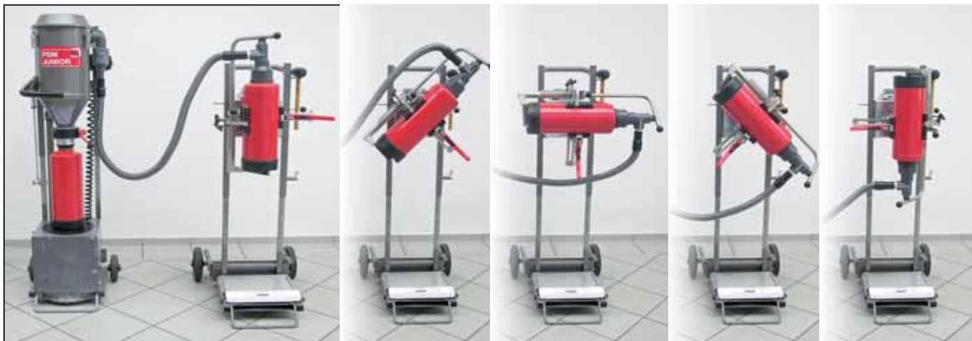
Nachdem der Feuerlöscher von der Halterung genommen wurde, wird er in die DSV eingespannt. Weitere manuelle Hebungen des Feuerlöschers zum Entleeren sind nicht mehr notwendig.
