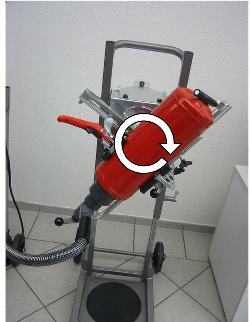
10. Adapter und Feuerlöscheröffnung nach oben positionieren. Entriegelungshebel in die Stellung Einrasten bringen. Die seitliche Klemmschraube (A) lösen, den Klemmbügel wegrehen und in einer nicht störenden Position fixieren.
