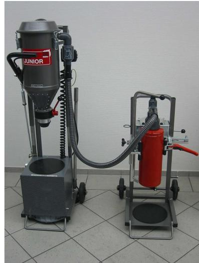
6. geerdeten Saugschlauch auf die Adaptertülle aufstecken.
