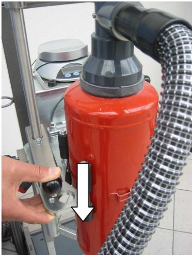
5. Spannhebel betätigen und seitliche Klemmschraube festziehen
