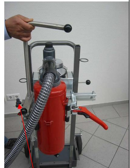
4. Klemmschraube lösen und Bügel über Adapter positionieren
