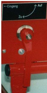
1. Kugelhahn öffnen und Anlage befüllen
