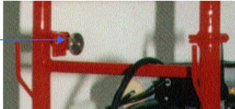
Durch Entriegelung des Entriegelungsgriffs lässt sich der Haltegriff an der **HPP S** umklappen und ermöglicht dadurch einen platz sparenden Transport.
