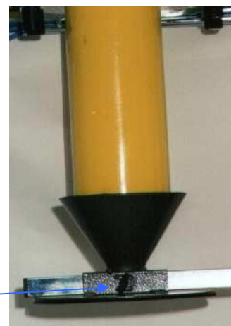
5. Teller oder Trichter durch Lösen der Schraube ggfs. solange waagrecht ver- schieben, bis Behälter senkrecht steht.
