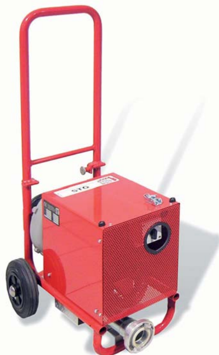
Bild 1: Das Schlauchtrockengerät STG wird zur Trocknung von Feuerwehrdruckschläuchen eingesetzt. Es hat einen einstellbaren, thermostatgeregelten Lufterhitzer.
