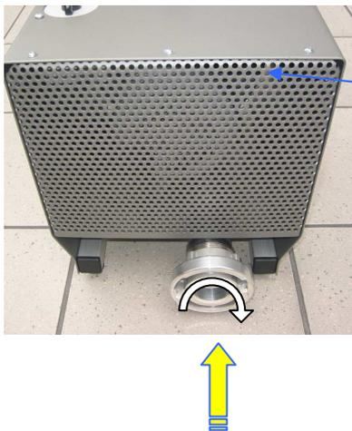
1. Zum Ankoppeln des Schlauches Kupplung mit Rasthaken ineinander stecken und verdrehen.
