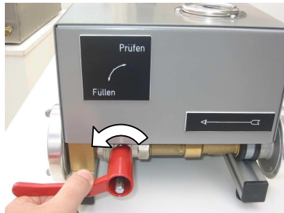
1. Kugelhahn „L“ öffnen und Anlage befüllen
