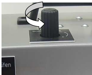
4. Druckregler gegen Uhrzeigersinn auf minimalen Druck einstellen
