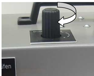
7. Gewünschten Druck durch Drehen des Druckreglers einstellen.
