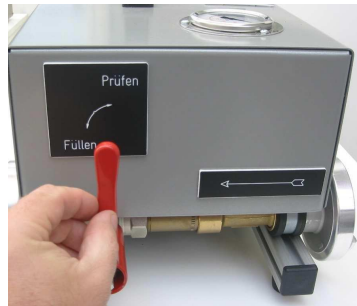
2. Kugelhahn „L“ schließen
