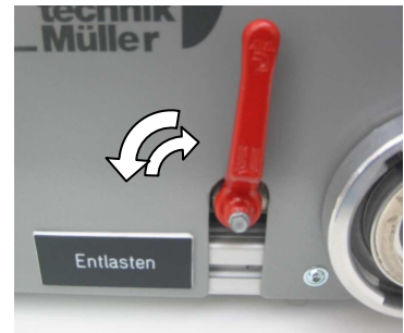
6. Entlastungskugelhahn „E“ kurzzeitig öffnen bis keine Luft mehr austritt
