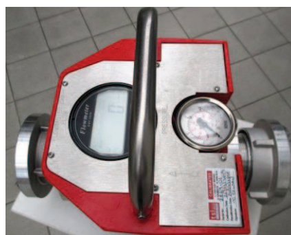
Abb.4.1: Analoger Flowmaster mit 2 Storz B – Kupplungen
