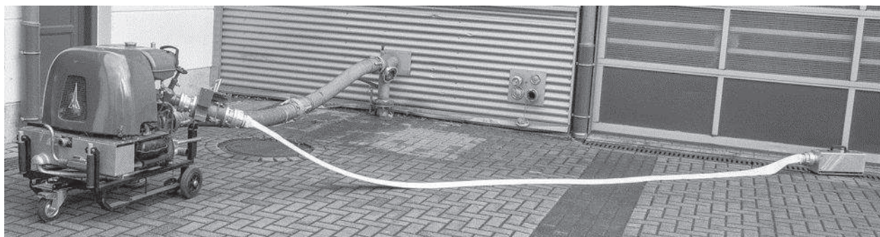
Abb. 4.3: Prüfung von Feuerwehrequipment mit Ein- und Auslaufstrecke
