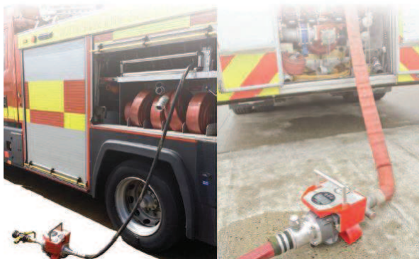
Abb. 4.3: Prüfung von Feuerwehrequipment mit Ein- und Auslaufstrecke
