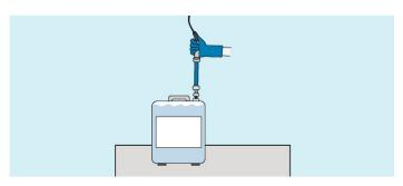
Das Produkt mit geeigneten Sauglanzen an das Dosiergerät anschließen.
