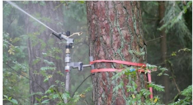
(stufenlos verstellbarer Baumhalter)
