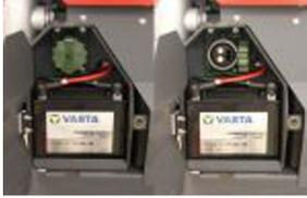
Die NATO - Steckdose dient als Aggregatanschluss zum Zweck einer Fremdstarthilfe.
