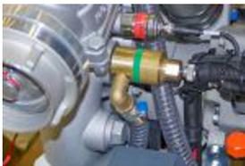
Schützt die Pumpe vor Überhitzung durch automatisches Öffnen des Ventiles bei einer Wassertemperatur von ca. 60°C.
