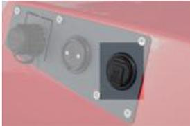
USB Doppelsteckdose mit Deckel. Zum Laden von Funkgeräten, Smartphones, usw.
