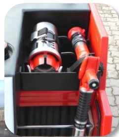
Aufsteckbarer Schaumwerfer: Großflächige Schaumteppiche in kürzester Zeit
