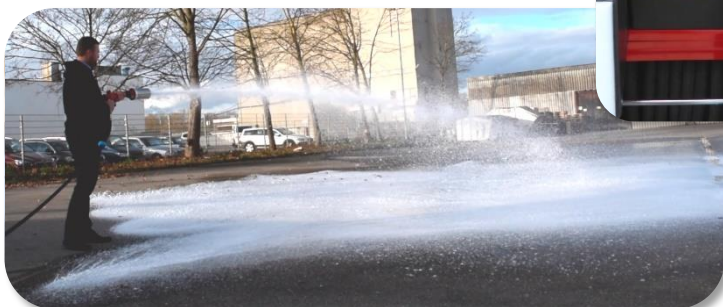
Aufsteckbarer Schaumwerfer: Großflächige Schaumteppiche in kürzester Zeit
