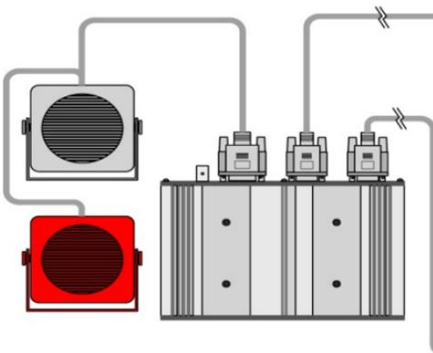
Von Sepura ist derzeit noch kein Dual-Lautsprecher-Adapterkabel verfügbar. Daher sollte beim Einbau ein entsprechendes Splitter-Kabel selbst montiert werden.
