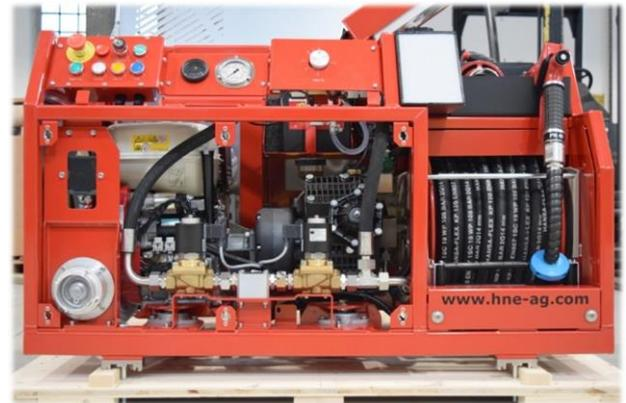
Lockern Sie die Fixierungsschrauben (Gabelschlüssel Nr. 17) um 1 bis 2 Umdrehungen. Die MFU ist jetzt in den Schienen beweglich und kann auf einen Hubwagen oder Gabelstapler verschoben werden. Schrauben Sie dann die Schienen von der Palette ab.
