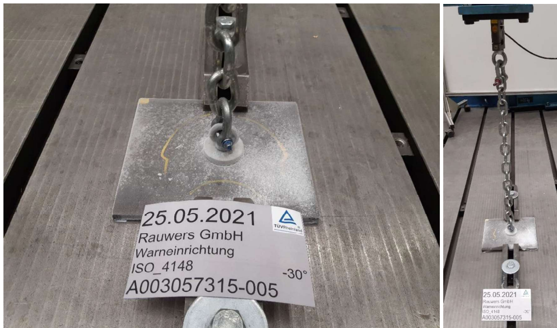
Abbildung A2.3 – Prüfaufbau Prüfung -30°C
