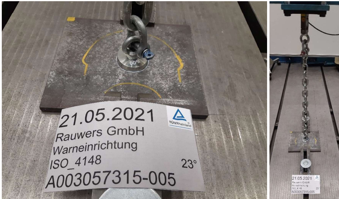
Abbildung A2.2 – Prüfaufbau Prüfung 23°C
