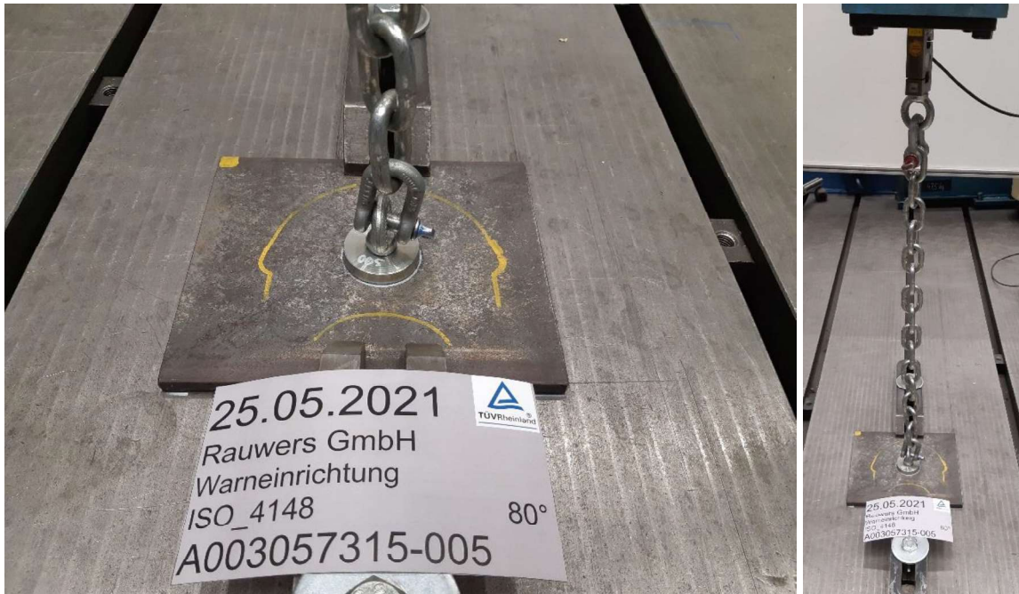
Abbildung A2.4 – Prüfaufbau Prüfung 80°C
