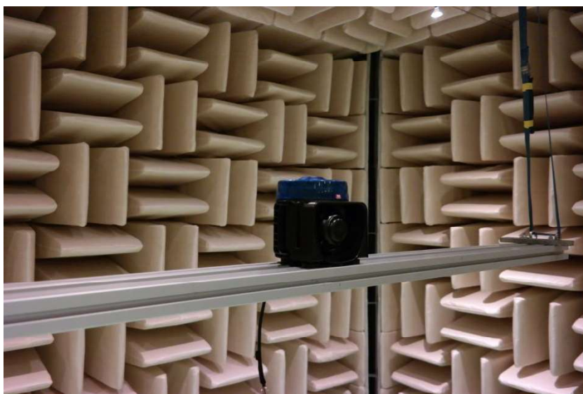
Bild 3: Messanordnung im reflexionsarmen Halbfreildmessraum
