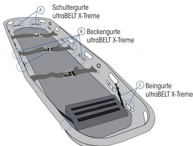
**Bild 6:** Teile des Gurtsystems ultraBELT X-TREME
