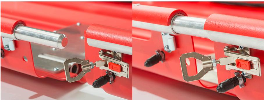
Alle Verschlüsse sind zur eventuellen Anpassung verstellbar. Dies geschieht über ein Gewinde an der Öse des Spanners. Dort findet man ebenfalls eine Kontermutter, die immer auf festen Sitz geprüft werden muss.
