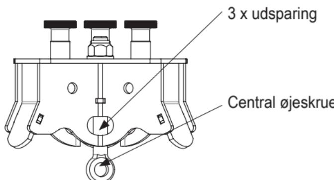
Faldsikringssystemet, som TRIBOC bruges til som ankerpunkt, skal være udstyret med et middel, der begrænser de dynamiske kræfter, der virker ved en faldsikring, til 6 kN. Hvis TRIBOC er udstyret med et særligt spil til nedfiring af last, kan der med dette spil nedsænkes værkøj eller maskin dele. Den maksimal tilladte last er:
