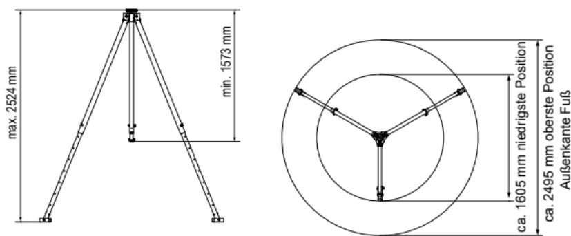
Die Standsicherheit muß durch einen ebenen rutschhemmenden Untergrund gewährleistet sein und im Rahmen einer komplett durchzuführenen Risikoanalyse im Einzelfall bewertet werden. Die Aufstandsfläche muss pro Bein eine vertikale Last von min. 5kN aufnehmen können (insgesamt inkl. Reserve 15 kN).
