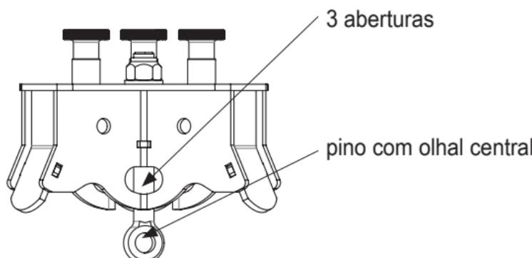
O sistema antqueda para que o TRIBOC é utilizado como ponto de ancoragem tem de dispor de meios que limitem a 6 kN as forças dinâmicas atuantes que ocorrem durante um processo antqueda. Desde que o TRIBOC esteja equipado com um guincho de carga, pode prescindir-se destas ferramentas ou componentes. A carga máxima admitida é de:
