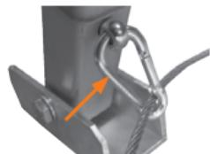
Collegare la fune d'acciaio mediante moschettone sulla 2a gamba sul bullone a occhiello
