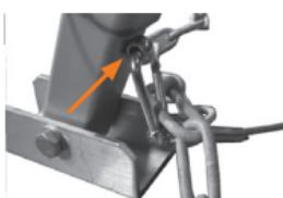
Collegare l'occhiello della fune d'acciaio con un moschettone al bullone a occhiello della gamba d'appoggio. (Figura 1 mostra, oltre all'installazione dell'occhiello della fune d'acciaio, anche il terminale della catena installato in base al punto di montaggio 4)
