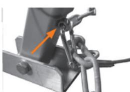
Fixer l'œillet du cordage acier sur la vis à œillet du pied à l'aide d'un mousqueton. (la figure 1 montre, outre l'installation de l'œillet du cordage acier, l'installation de l'extrémité de la chaîne expliquée au point de montage 4)
