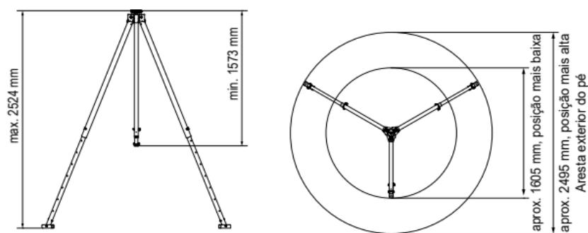
A estabilidade tem de ser garantida por uma base plana e antiderrapante, e de ser individualmente avaliada no âmbito de uma análise completa dos riscos que tem de ser levada a cabo. A superfície de contacto tem de estar apta a suportar uma carga vertical mínima de 5 kN por perna (no total, incluindo uma reserva de 15 kN).
