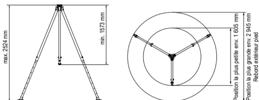
S'assurer que le sol est bien plat et antidérapant afin de garantir un positionnement sûr. Ce dernier doit être évalué pour chaque utilisation à l'aide d'une analyse complète des risques. La surface de contact doit être capable d'absorber une charge verticale minimale de 5 kN par pied (15 kN au total avec une réserve).
