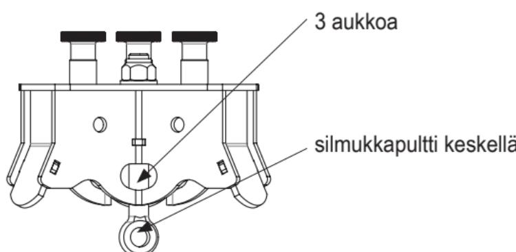
Sen pysäytysjärjestelmän, jolle TRIBOC-laitetta käytetään kiinnityskohtana, täytyy olla varustettu välineellä, joka rajoittaa pysäytämisessä vaikuttavat dynaamiset voimat arvoon 6 kN. Jos TRIBOC on varustettu kuormavinturilla, sillä voidaan laskea alas työkaluja tai koneen osia. Suurin sallittu kuorma on:
