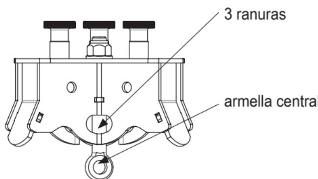
El sistema de sujeción para el que se use TRIBOC como punto de anclaje debe estar equipado con un medio que limite a 6 kN las fuerzas dinámicas generadas durante la amortiguación. Si TRIBOC está equipado con un cabestrante, puede utilizarse para sacar herramientas o componentes de máquinas. La carga máxima autorizada es la siguiente:
