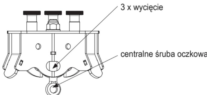
System zabezpieczający przed upadem z wysokości, dla którego został zastosowany trójnóg TRIBOC jako punkt kotwiczący, musi być wyposażony w narzędzie, które pozwoli na ograniczenie do 6 kN oddziałującej podczas uruchomienia zabezpieczenia przed upadem z wysokości dynamicznej siły. Jeśli TRIBOC został wyposażony w kołowrotek, to można używać go do spuszczania narzędzi lub elementów maszyny. Maksymalnie dopuszczalne obciążenie wynosi:
