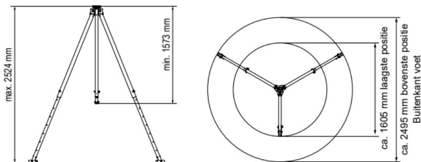
De stabiliteit moet door een effen, slipvrije ondergrond gegarandeerd zijn en binnen het kader van een volledig uit te voeren risicoanalyse per geval worden beoordeeld. Het plaatsingsvlak moet per poot een verticale belasting van min. 5kN kunnen dragen (in totaal incl. reserve 15 kN).
