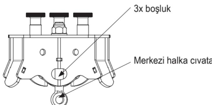
TRIBOC'un dayanma noktası olarak kullanıldığı güvenlik kemeri sistemi, tutma işlemi esnasında etki eden dinamik kuvvetleri 6kN'ye düşüren bir araçla donatılmış olmalıdır. TRIBOC bir yük kasnağıyla donatılmışsa, bu aletlerle veya makine parçalarıyla tahliye edilebilir. İzin verilen maksimum yük:
