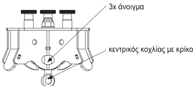
Το σύστημα ανάσχεσης, για το οποίο το TRIBOC θα χρησιμοποιηθεί ως σημείο αγκύρωσης, πρέπει να είναι εξοπλισμένο με διάταξη η οποία θα περιορίζει τα δυναμικά φορτία στα 6kN στην περίπτωση ανάσχεσης. Εάν το TRIBOC είναι εξοπλισμένο με βίντσι, μπορείτε με αυτό να κατεβάσετε εργαλεία ή εξαρτήματα μηχανημάτων. Το μέγιστο επιτρεπόμενο φορτίο ανέρχεται σε:
