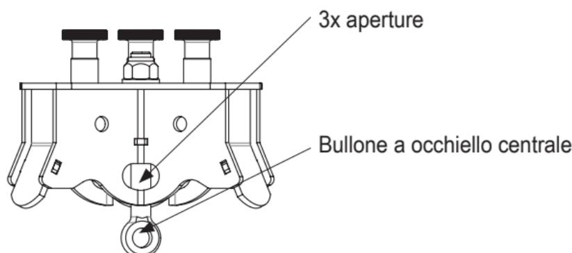
Il sistema di arresto per il quale il TRIBOC viene usato come punto di ancoraggio, deve essere dotato di un dispositivo in grado di limitare a 6kN le forze dinamiche risultanti da un'azione di arresto. Qualora il TRIBOC sia attrezzato con un verricello, con esso si possono scaricare attrezzi o parti di macchinari. Il carico massimo consentito è pari a:
