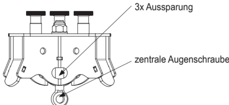
Das Auffangsystem, für welches der TRIBOC als Anschlagpunkt genutzt wird, muss mit einem Mittel ausgestattet sein, welches die bei einem Auffangvorgang wirkenden dynamischen Kräfte auf 6kN begrenzt. Sofern der TRIBOC mit einer Lastwinde ausgerüstet ist, können mit dieser Werkzeuge oder Maschinenteile abgelassen werden. Die maximal zulässige Last beträgt:
