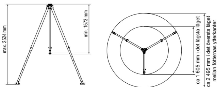
Stabiliteten måste säkerställas genom ett glidsäkert underlag och i varje enskilt fall bedömas inom ramen för en fullständig riskanalys. Uppställningsytan måste kunna bära en vertikal belastning på 5 kN per ben (samtaget inkl. reserv 15 kN).
