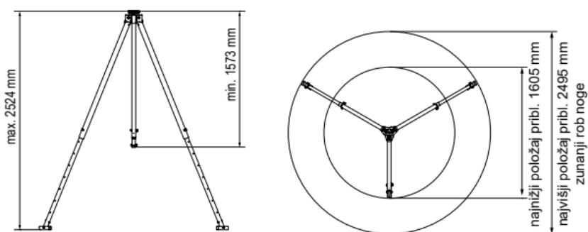
Stabilnost izdelka je treba zagotoviti z ravno in nedrsečo podlago ter jo v posameznih primerih oceniti v okviru celovito izvedene analize tveganj. Nosilna površina mora na vsaki nogi vzdržati vertikalno obremenitev min. 5 kN (skupaj z rezervo 15 kN).
