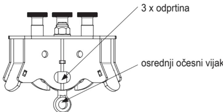
Sistem prestrezanja, pri katerem se TRIBOC uporablja kot pritrdilna točka, mora biti opremljen z elementom, ki dinamične sile, ki nastanejo pri prestrezanju, omeji na 6 kN. Če je TRIBOC opremljen z vitlom za breme, uporaba orodja ali strojnih delov ni obvezna. Največja dovoljena obremenitev je:
