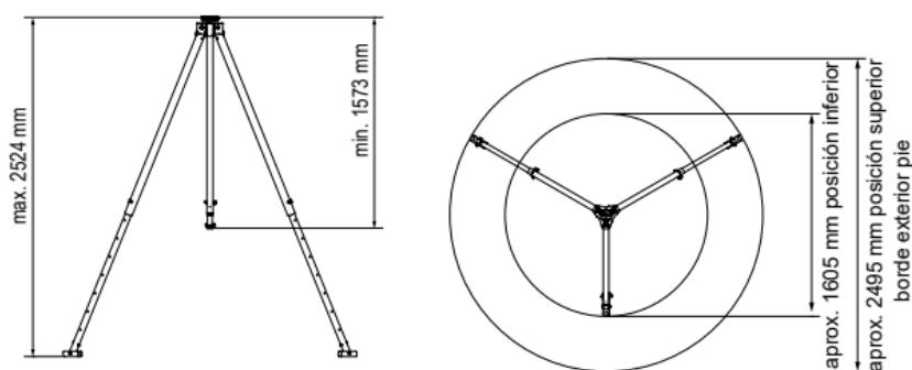
Debe garantizarse la seguridad colocando el trípode en una superficie lisa y que no resbale y realizando un análisis de los riesgos integral en cada caso concreto. La superficie de apoyo debe poder soportar por pata una carga vertical de mínimo 5 kN (en total, con reserva incl., 15 kN).
