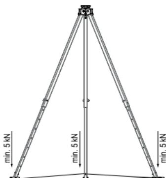
En fonction de la situation, une attention toute particulière doit être portée à la sécurité individuelle dès le montage. La zone de travail (direction de la chute) se situe dans l'enceinte du triangle formé à l'aide des pieds et de la chaîne. Une chute du trépied vers l'extérieur ou une oscillation liée à une ascension ou une descente non verticale vis-à-vis du point d'ancrage (dans le sens de la chute dans le pire des cas) doivent impérativement être évitées.
