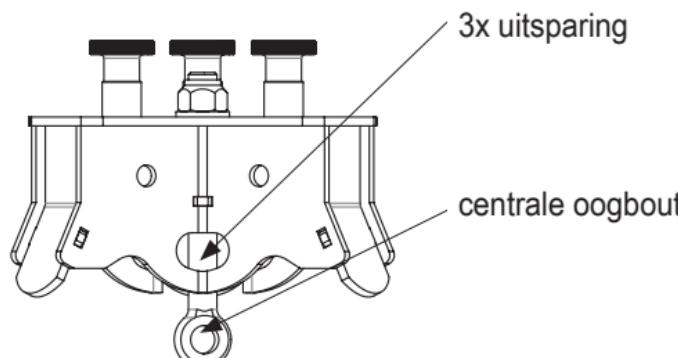
Het valbeveiligingsysteem waarvoor de TRIBOC als aanslagpunt wordt gebruikt, moet van een hulpmiddel zijn voorzien dat de dynamische krachten bij een val tot 6kN beperkt. Indien de TRIBOC is voorzien van een lier, kunnen hiermee gereedschappen of machineonderdelen worden neergelaten. De maximaal toegestane belasting bedraagt:
