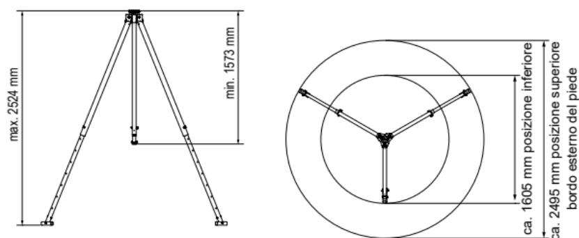
La stabilità del dispositivo deve essere garantita attraverso un fondo antiscivolo e valutata singolarmente nell'ambito di un'analisi completa dei rischi. Per ciascuna gamba, la superficie di appoggio deve essere in grado di sopportare un carico verticale di min. 5kN (complessivamente, incl. riserva, 15 kN).
