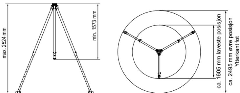
Stabiliteten må sikres ved hjelp av et plant, sklihemmende underlag som må vurderes som del av en fullstendig risikoanalyse i hvert enkelt tilfelle. Underlagsflaten må kunne tåle en last per bein på 5 kN (totalt, inkludert reserve på 15 kN.)
