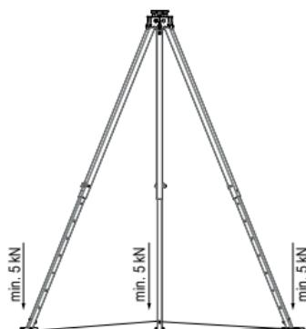
Afhængigt af det pågældende setup skal egensikringen mod nedstyrtnings allerede overholdes ved opbygningen. Arbejdsmønstret (aktivitetsretning ved et styrt) ligger inden for den trekant, der er markeret ved de tre ben og den opsatte kæde. Omstyrtnings af trefoden udadtil eller pendulering på grund af en i forhold til ankerpunktet ikke-vertikal ned- eller opstigning (i værste fald nedstyrtningsretning) skal under alle omstændigheder undgås.
