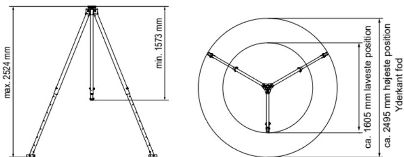
Standsikkerheden skal sikres ved at bruge et jævnt og skridsikkert underlag og skal i hvert enkelt tilfælde bedømmes som et led den komplette risikoanalyse. Bærefladen skal pr. ben kunne optage en vertikal last på min. 5kN pr. (i alt inkl. reserve 15 kN).
