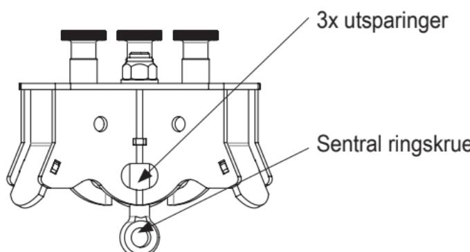
Fangsystemet TRIBOC brukes som festepunkt for må være utstyrt med en mekanisme som begrenser de dynamiske kreftene ved fallbremsing til 6 kN. Hvis TRIBOC er utstyrt med en lastevinsj, er ikke disse verktøyene eller maskindelene nødvendige. Maksimalt tillatt last er:
