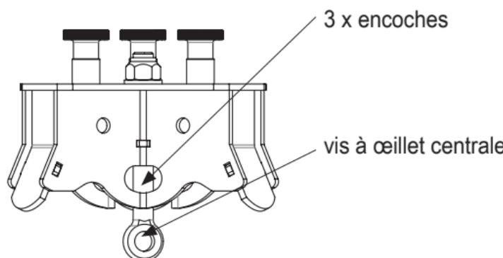
Le système d'arrêt des chutes, pour lequel le TRIBOC est utilisé comme point d'ancrage, doit être équipé d'un dispositif qui limite les forces dynamiques à 6 kN en cas d'arrêt. Si le TRIBOC est équipé d'un treuil, il peut permettre l'évacuation d'outils ou de pièces mécaniques. La charge maximale autorisée s'élève à :
