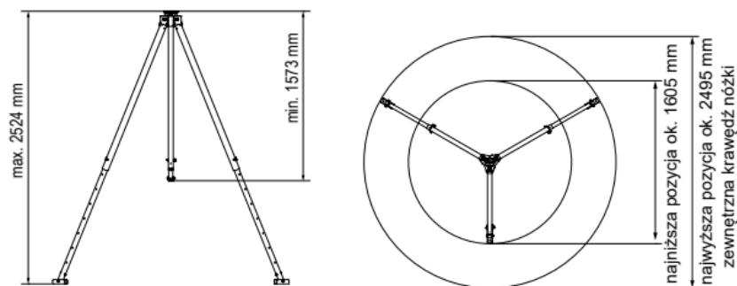
Zagwarantowana musi być stateczność przez równe antypoślizgowe podłożę oraz odpowiednio oszacowanie w ramach kompletnie przeprowadzonej analizy ryzyka w każdym poszczególnym przypadku. Powierzchnia styku musi mieć zdolność przyjmowania pionowego obciążenia na każdej nodze min. 5 kN (w sumie łącznie z rezerwą 15 kN).
