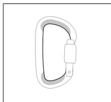
• Kontrollieren Sie Abnutzungserscheinungen, die vom durchlaufenden Seil oder durch Aufliegen an Anschlagpunkten verursacht wurden (Materialabtrag: Eine Abnutzung von mehr als 1 mm ist gravierend, Auftreten von scharfen Kanten usw.).
