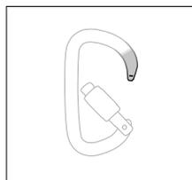
• Überprüfen Sie den Zustand der Nase (Kratzer, Abnutzungserscheinungen, Risse, Verformung usw.).
