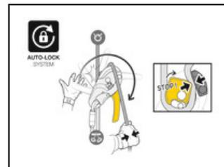
Das AUTO-LOCK-System ermöglicht es dem Anwender, sich am Arbeitsplatz zu positionieren, ohne den Hebel betätigen und das Gerät abbinden zu müssen: Sobald er den Hebel loslässt, wird das Seil automatisch im Gerät blockiert.
