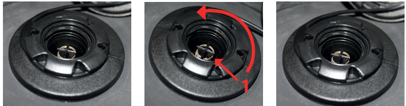
Stift vor Arretierung Eindrücken + drehen Stift nach Arretierung
