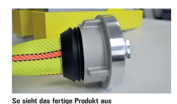
Nach Verpressung -> Prüfung gemäß den Sicherheitshinweisen
