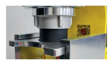
**Montage**Alle Bauteile sind nun bereit zum Verpressen
