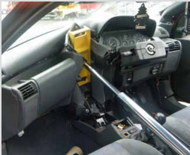
Sicherung des Rettungszyinders, das Abrutschen wird verhindert.
