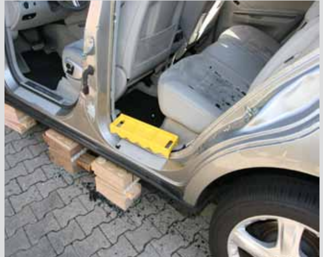
Hier kann die Druckplatte mittels Spreizer fixiert werden.
