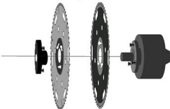
Schrauben lose in den Adaptern befestigen
