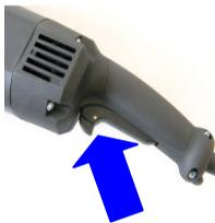
Drücken Sie mit dem Zeigefinger den Schalter nach vorne und dann mit den anderen Fingern den Hauptschalter nach oben.
