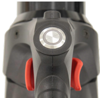
Beispiel Schneidergerät: links schließen, rechts öffnen
