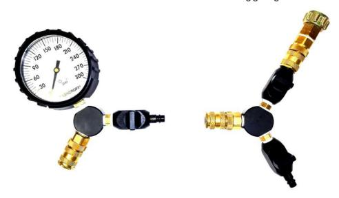
2. Setzen Sie das Testmanometer mit der Nippelseite in den Ausgang des Steuergerätes ein und sichern den Verriegelungsring. Hinweis: Stellen Sie sicher, dass das Absperrorgan auf "geschlossen" steht.
