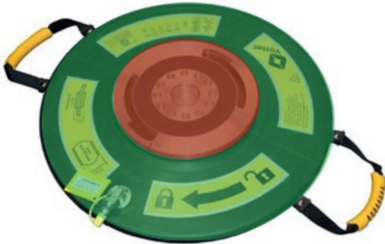
Mit zunehmender Hubhöhe nimmt das Hebekissen eine abgeflachte Kugelform an, ggf. neigt sich die Last durch einen einseitigen Hubvorgang um einen Drehpunkt. Dadurch nimmt die Kontaktfläche zur Last bis zur vordefinierten Endhubkraft bei definierter Hubhöhe ab. Die größtmögliche Hubhöhe erreicht das Hebekissen nur im unbelasteten Zustand.
