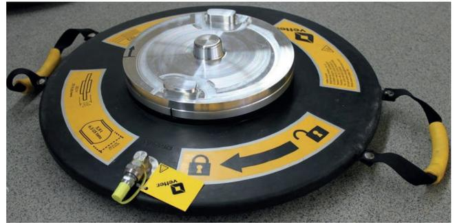
2. Anschließend das obere Kissen auf die bereits montierte Verbindungsplatte aufsetzen. Dabei muss das Ventil des oberen Kissens vertikal zum geöffneten Schloss des unteren Kissens positioniert werden. Die Haken der Verbindungsplatte müssen im Kissen eingesteckt sein. Jetzt das obere Kissen mit dem Uhrzeigersinn drehen, bis das Kissen gegen den Endanschlag stößt und die Luftanschlüsse beider Kissen vertikal zueinander stehen.
