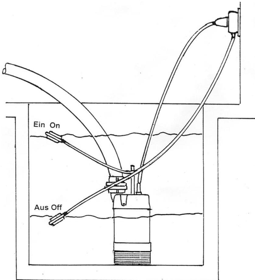
Schwimmerschalterleitung steckbar, Fixierung am Tragegriff oder an der Innenseite der Schachtwand.
