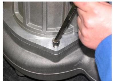
8. Setzen Sie den Tragekorb über die Pumpe und verschrauben ihn mit den sechs Zylinderschrauben mit Innensechskant (M12) mit der Pumpe (siehe Bild). Zur Sicherung der Schrauben ist mittelfeste Schraubensicherung zu verwenden.
