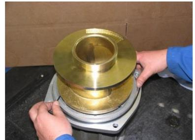
6. Setzen Sie das Spiralgehäuse über das montierte Laufrad auf den Motorflansch.
