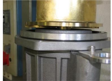
4. Verschrauben Sie das Laufrad mit der Motorwelle mittels der Zylinderschraube mit Innensechskant (M8). Zur Sicherung der Schraube ist hochfeste Schraubensicherung zu verwenden. Das richtige Schraubenanzugsdrehmoment entnehmen Sie bitte der Tabelle 6.3.1 Schraubenanzugsdrehmomente.
