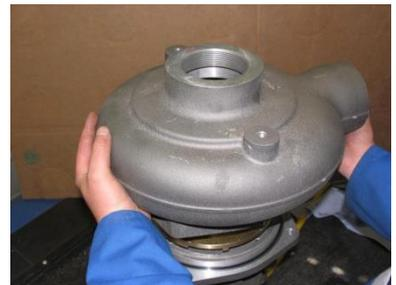
7. Verschrauben Sie das Spiralgehäuse mit den vier Zylinderschrauben mit Innensechskant (M12) mit dem Motor. Zur Sicherung der Schrauben ist mittelfeste Schraubensicherung zu verwenden. Das richtige Schraubenanzugsdrehmoment entnehmen Sie bitte der Tabelle 6.3.1 Schraubenanzugsdrehmomente.
