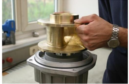
3. Das Laufrad ist bis zum Anschlag aufzupressen. (Einpresstiefe: 27 mm)
