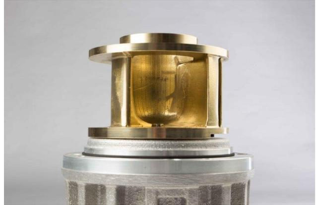
4. Verschrauben Sie das Laufrad mit der Motorwelle mittels der Zylinderschraube mit Innensechskant (M8). Zur Sicherung der Schraube ist hochfeste Schraubensicherung zu verwenden. Das richtige Schraubenzugsdrehmoment entnehmen Sie bitte der Tabelle 6.4.1 Schraubenzugsdrehmomente.
