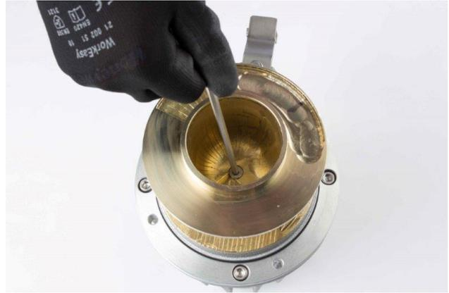
5. Ziehen Sie das Laufrad von der Welle ab. Bei Schwergängigkeit benutzen Sie das als Sonderzubehör erhältliche Abziehwerkzeug. Reinigen und überprüfen Sie die Polygonverbindung auf Beschädigungen.
