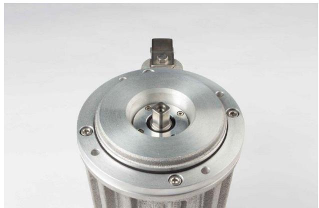
2. Setzen Sie das Laufrad gerade auf der Motorwelle auf und drücken Sie es bis zum Anschlag herunter.
