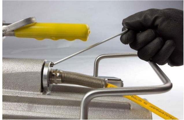
2. Ziehen Sie die Kabelverschraubung samt Stecker und Kupplung aus dem Gehäuse heraus. Öffnen Sie die Steckverbindung und ziehen den Stecker aus der Kupplung heraus.
