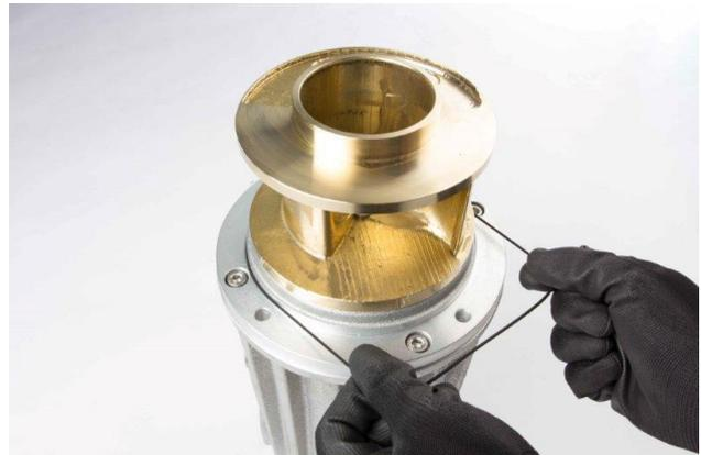
6. Setzen Sie das Spiralgehäuse über das montierte Laufrad auf den Motorflansch.
