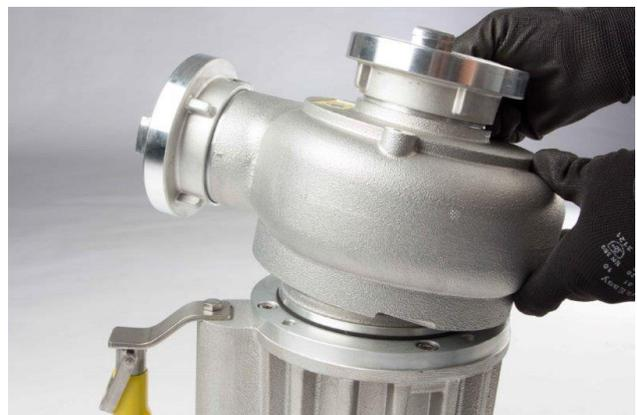
7. Verschrauben Sie das Spiralgehäuse mit den vier Zylinderschrauben mit Innensechskant (M8) mit dem Motor. Zur Sicherung der Schrauben ist mittelfeste Schraubensicherung zu verwenden. Das richtige Schraubenzugsdrehmoment entnehmen Sie bitte der Tabelle 6.3.1 Schraubenzugsdrehmomente.
