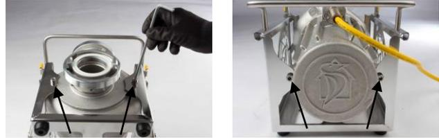
2. Entfernen Sie die vier Zylinderschrauben mit Innensechskant (M8) vom Spiralgehäuse.
