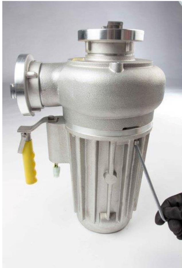
8. Setzen Sie die Pumpe in den Tragekorb und schrauben sie mit den vier Zylinderschrauben mit Innensechskant (M8) in den Tragekorb. Zur Sicherung der Schrauben ist mittelfeste Schraubensicherung zu verwenden. Das richtige Schraubenzugsdrehmoment entnehmen Sie bitte der Tabelle 6.4.1 Schraubenzugsdrehmomente.
