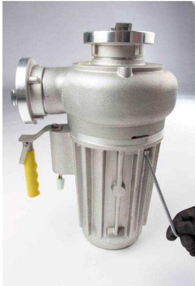
3. Entfernen Sie das Spiralgehäuse. Bei hartnäckigen Verstopfungen ist es gegebenenfalls notwendig mit Hilfe von zwei Schraubenziehern das Spiralgehäuse zu entfernen. Setzen Sie hierzu die Schraubenzieher an den beiden dafür vorgesehenen Demontageschlitz am Spiralgehäuse an und hebeln damit das Spiralgehäuse ab.
