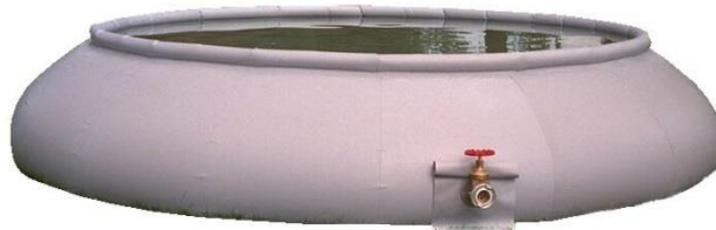
gefertigt aus PES/ Alcryn® mit einer Reißfestigkeit von mindestens 3000 N/5 cm, Flächengewicht: ca. 1300 g/m<sup>2</sup>, Luft-befüllbarer Schwimmwulst mit Druckluftanschluss  $\frac{3}{8}$ " und Überdruck-/Entlüftungsventil, 4 Stück D-Ringe im Bodenbereich, Armaturen mit Armaturenschutz, inkl. Packtasche
