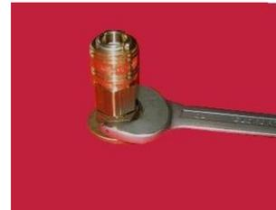
Kontrollieren Sie, ob das Überdruckventil festgezogen ist. Ziehen Sie die Bauteile ggf. von Hand nach. **Nicht überdrehen!**
