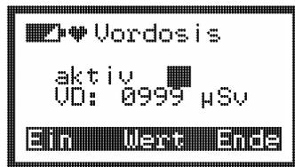
Der Cursor befindet sich zunächst hinter dem Schriftzug „aktiv“. Hier können Sie ein Häkchen setzen, um den vorgegebene Wert zu aktivieren oder dieses entfernen, um den Vordosisbetrieb zu beenden. Drücken Sie dazu die linke Taste **Ein** oder **Aus**. Wenn Sie dies getan haben oder das Menü verlassen möchten, drücken Sie die rechte Taste **Ende**.
