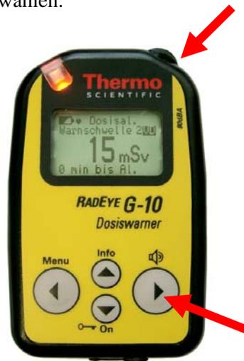
Wenn kein Alarm ausgelöst ist, wird von der höchsten Warnschwelle (250 mSv) durch einen langen Tastendruck wieder auf die niedrigste Schwelle (1 mSv) gesprungen. Im Alarmfall ist dies nicht möglich.
