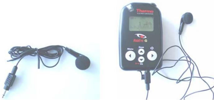
Der Kopfhörer wird an der Unterseite des Gerätes angeschlossen, nachdem der Gummistöpsel geöffnet wurde.
