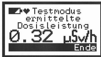
Der Anzeigebereich startet bei  $0.01 \mu\text{Sv/h}$  und ist somit auch für einen Test mit reiner Umgebungsstrahlung geeignet.
