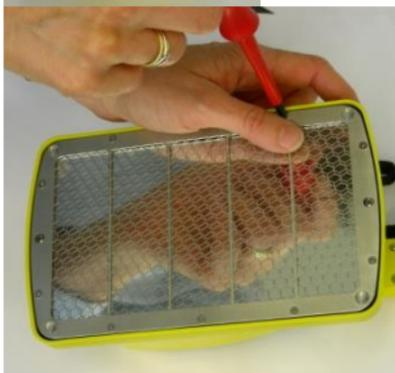
Nach dem Lösen der Schrauben kann das Wa-bengitter entfernt werden.
