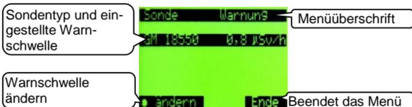
Die Warnschwelle kann in einem Bereich von 0,1  $\mu\text{Sv/h}$  bis 19,99 mSv/h eingestellt werden. Zur Umschaltung der Einheit diese auswählen und mit den Pfeiltasten die gewünschte Einheit  $\mu\text{Sv/h}$  oder mSv/h einstellen.
