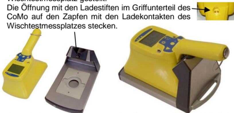
Je nach Parametrierung misst das Gerät ständig den Nulleffekt und schaltet beim Einlegen eines Messgutes (Öffnen und Schließen der Lade) auf Kontaminationsmessung um.
