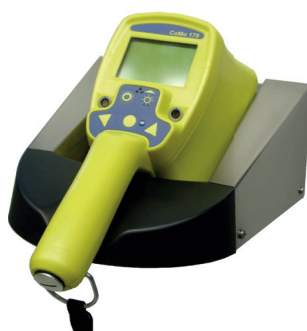
stationärer Einsatz des CoMo-Systems in aktiver Wandstation
