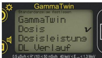
Hier wird die Anzeige festgelegt, die nach dem Einschalten des GammaTwin S und beim Verlassen des Menüs erscheint. Die jeweils aktive Standardanzeige ist durch einen Haken gekennzeichnet. Mit Hilfe der Taste ⌚ kann durch die Anzeigen geblättert werden. Mit der Taste ◻ wird die invertiert dargestellte Zeile ausgewählt und zur Standardanzeige. Durch nochmaliges Drücken der Taste ◻ verlässt man das Menü.
