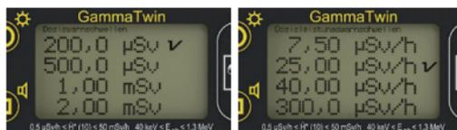
In diesen beiden Menüs wird die jeweils aktive Warnschwelle durch einen Haken gekennzeichnet. Mit Hilfe der Taste  $\odot$  kann durch die einzelnen Warnschwellen geblättert werden. Mit der Taste  $\odot$  wird die invertiert dargestellte Warnschwelle ausgewählt (helle Schrift auf dunklem Hintergrund) und zur aktiven Warnschwelle. Durch nochmaliges Drücken der Taste  $\odot$  wählt man den nächsten Menüpunkt.
