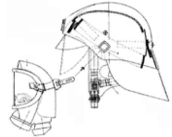
Die Maske kann wieder abgenommen werden, indem die außenliegenden Drucktasten gedrückt gehalten werden und gleichzeitig die Maske mit Hilfe der seitlich angebrachten Maskenriemen leicht nach hinten gezogen wird (Verriegelungsfunktion).
