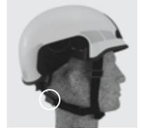
Die Länge des Kinnriemens lässt sich individuell für unterschiedliche Gesichtsformen an zwei Positionen einstellen. Die senkrecht verlaufenden Bänder können über die links und rechts befindlichen Schieber in ihrer Länge angepasst werden.
